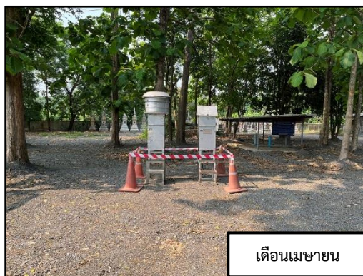
ภาพที่ 3.3 การตรวจวัดคุณภาพอากาศในบรรยากาศบริเวณชุมชนบ้านชะมอใต้
